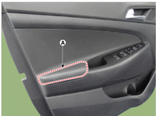
5. 拆卸电动门窗开关总成(A)。
