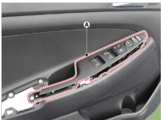
6. 拧下固定螺钉，拆卸电动门窗开关(A)。
